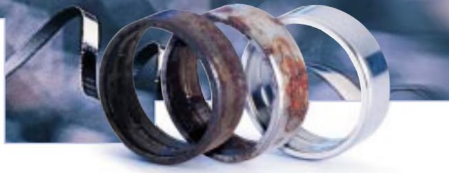
Testergebnisse im Salzsprühtest nach DIN 50021 / ASTM B117-73
