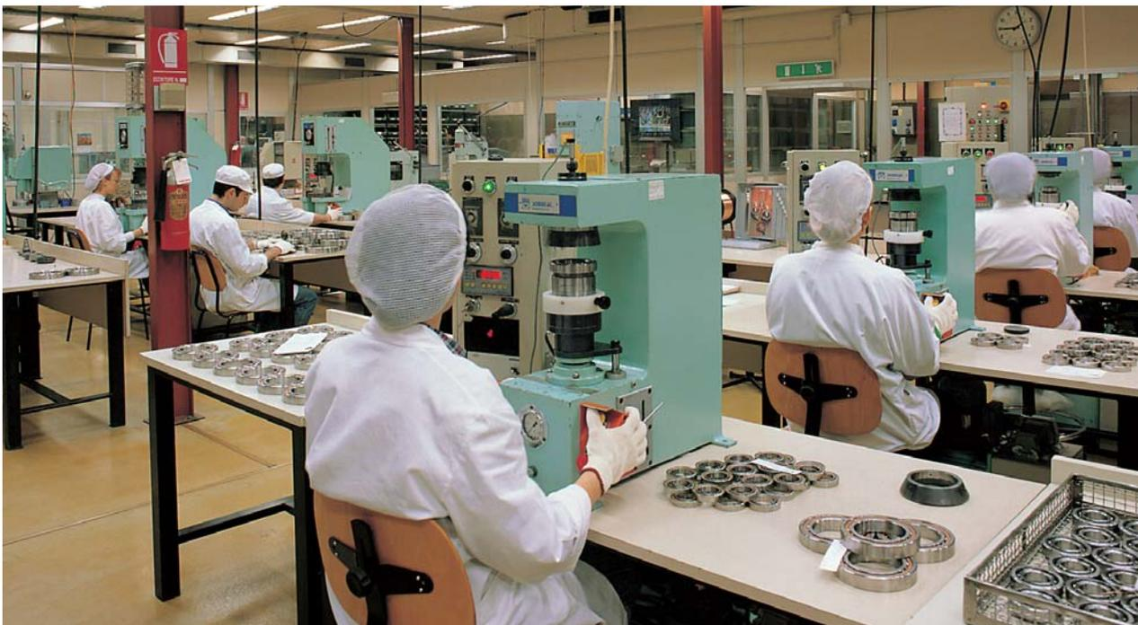
Les cages en textile-résine stratifié sont réalisées à partir des tubes.
