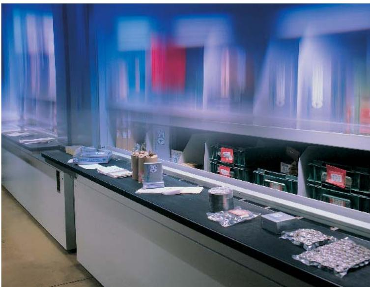
En attente de livraison, le stockage des roulements se fait dans un magasin avec une température et un taux d'humidité contrôlés en permanence.
