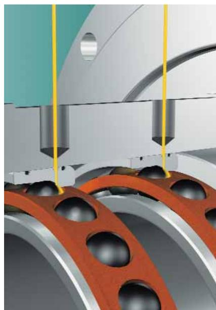
Ein homogener Ölfluss ist von grundsätzlicher Bedeutung. Eine separate, individuelle Schmierung jedes einzelnen Lagers wird dringend empfohlen.
