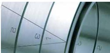
Der Pfeil "V", der sich auf der Oberfläche des Aussendurchmessers der Lager befindet, gibt die Richtung der Axialkrafteinleitung und die jeweilige Position der Lager im Satz an. Der Pfeil befindet sich auf der Position der maximalen Rundheitsabweichung der Aussenringe.
