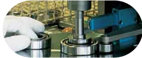
Paarung ist die Operation, bei der aus Einzellagern Lagergruppen erstellt werden.
