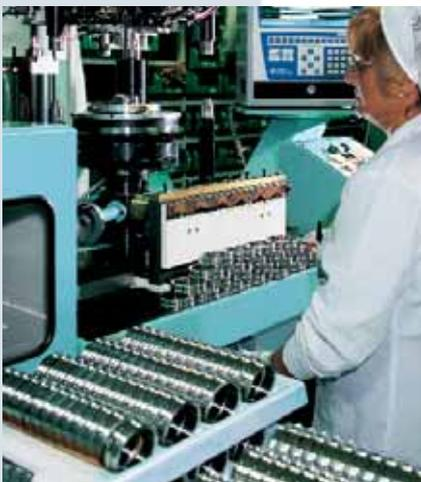
Der Phenolharzkäfig (Hartgewebe) wird vom Halbfabrikat Rohr gefertigt.
