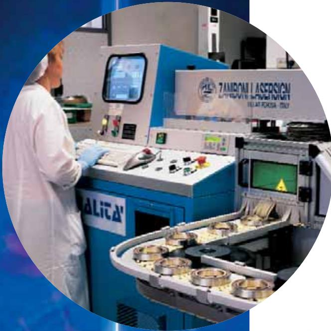
Die Kennzeichnung der Lager erfolgt durch einen computergeführten Laser und beinhaltet die komplette Lagerbezeichnung, d.h. Basistyp, Genauigkeitsklasse, Druckwinkel, Paarung und Vorspannung.
