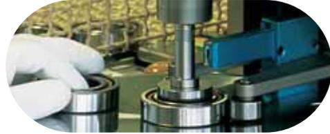
L'accoppiamento è l'operazione con cui vengono formati i gruppi di due o più cuscinetti e si realizza, nel contempo, il precarico prestabilito. L'esattezza e l'uniformità del precarico sono requisiti peculiari affinché il funzionamento dei gruppi sia regolare. Per ottenere tale risultato la SNFA si avvale di apposite apparecchiature grazie alle quali l'applicazione del carico assiale prescritto e la corrispondente lettura del salto facciale dei cuscinetti avvengono con estremo rigore.
