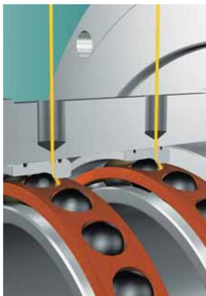
L'adduzione del flusso aria-olio ai cuscinetti deve avvenire senza perdite lungo il percorso ed in modo omogeneo. È pertanto fortemente raccomandabile che ogni cuscinetto venga alimentato individualmente, anche se, a volte, si deve ricorrere ad un sistema di condutture più elaborato.
