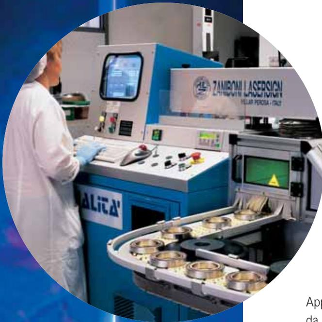
Apparecchiature sofisticate dotate di raggio laser, pilotato da computer, provvedono alla marcatura. Il prodotto marcato è completamente identificabile: la marcatura include i codici che caratterizzano, oltre al tipo base, il grado di precisione, l'angolo di contatto e il tipo di accoppiamento.
